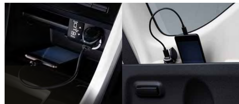
DC 12V ACCESSORY POWER SOCKET AT FRONT CONSOLE AND 3 RD ROW SEAT ช่องจ่ายกระแสไฟ DC 12 โวลต์ บริเวณคอนโซลด้านหน้าและเบาะหลังแถวที่สาม
